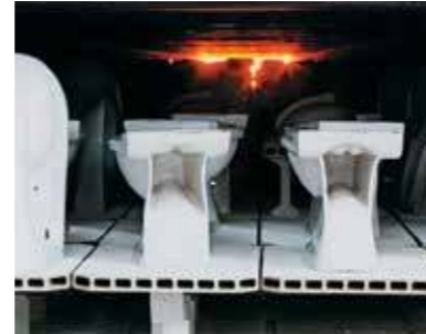
Высушенные и покрытые глазурью заготовки подвергаются обжигу при максимальной температуре 1240 °C.
